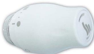
Если на термоголовке выставлено значение IIII, то при достижении температуры воздуха в помещении 22°C, термоголовка перекроет подачу теплоносителя, и радиатор будет оставаться холодным до тех пор, пока температура воздуха в помещении не снизится до 21,5°C. Затем терморегулятор откроет клапан и будет держать его открытым пока воздух в комнате не достигнет 22,5°C, затем снова закроется и радиатор будет холодным.
